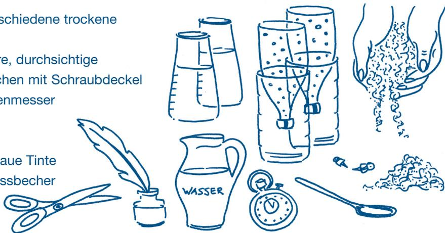
Zunächst schraubst du die Deckel von den Flaschen ab und stichst mit der Reißzwecke einige Löcher hinein. Dreh die Deckel wieder drauf, und schneide die beiden PET-Flaschen vorsichtig in der Mitte durch. Nun stellst du jeweils das Flaschenoberteil umgedreht wie einen Filter in das Flaschenunterteil (siehe Zeichnung).
