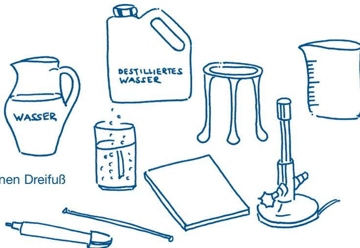
Zunächst schreibst du die Zahlen 1, 2 und 3 auf die Glasplatte. Dann füllst du das Becherglas ein bis zwei Zentimeter hoch mit Wasser und legst die Glasscheibe obendrauf. Jetzt bringst du das Wasser zum Kochen (entweder auf der Herdplatte oder auf dem Dreifuß mit dem Bunsenbrenner). Mit dem Glasstab gibst du neben die „1“ ein paar Tropfen destilliertes Wasser, neben die „2“ Leitungswasser und neben die „3“ Mineralwasser. Warte, bis die Wassertropfen auf der Scheibe verdunstet sind.
